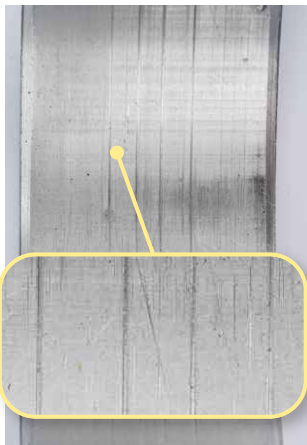
Вкладыш подшипника коленчатого вала с искусственными повреждениями
