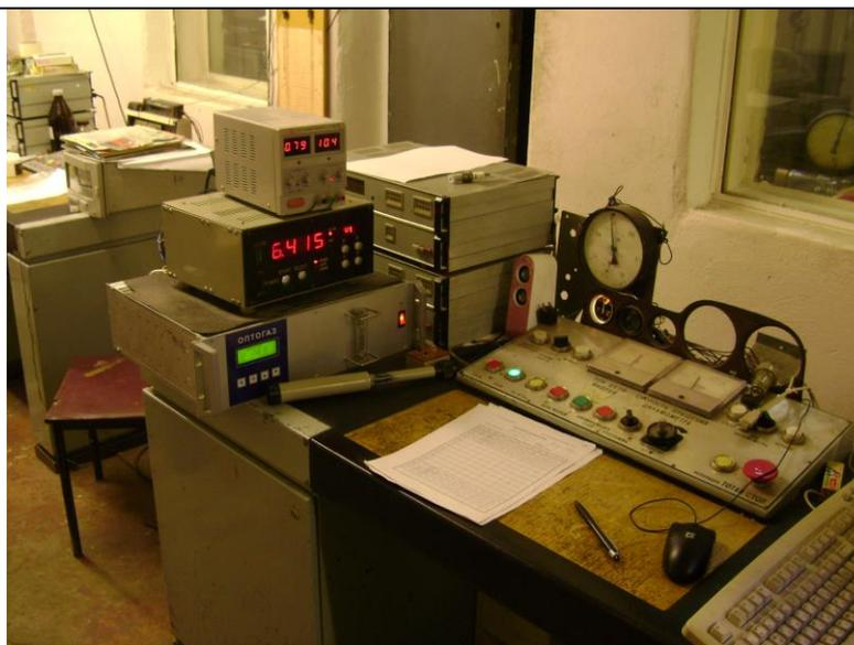
Рис. 2. Пульт управления стендом. Расходомер топлива и газоанализатор.
