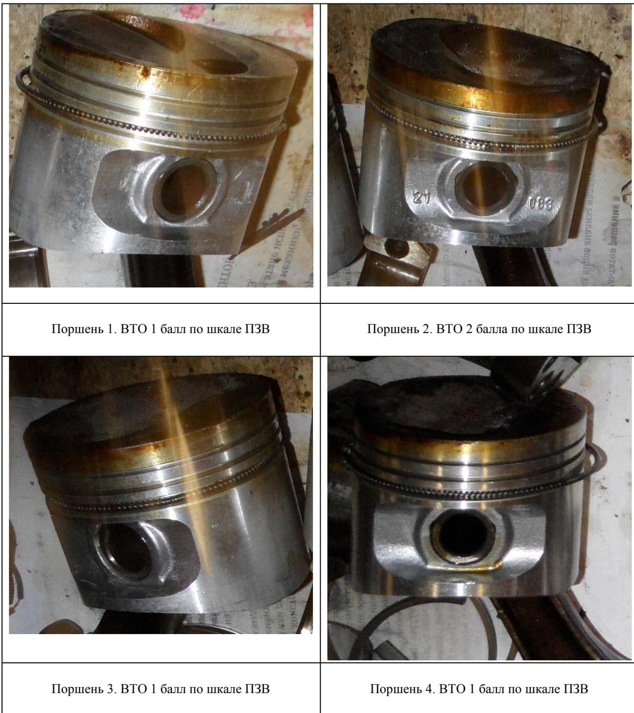
Рис.47. Высокотемпературные отложения (ВТО) поле длительных испытаний двигателя на моторном масле Castrol EDGE Professional 0W-20 Titanium
