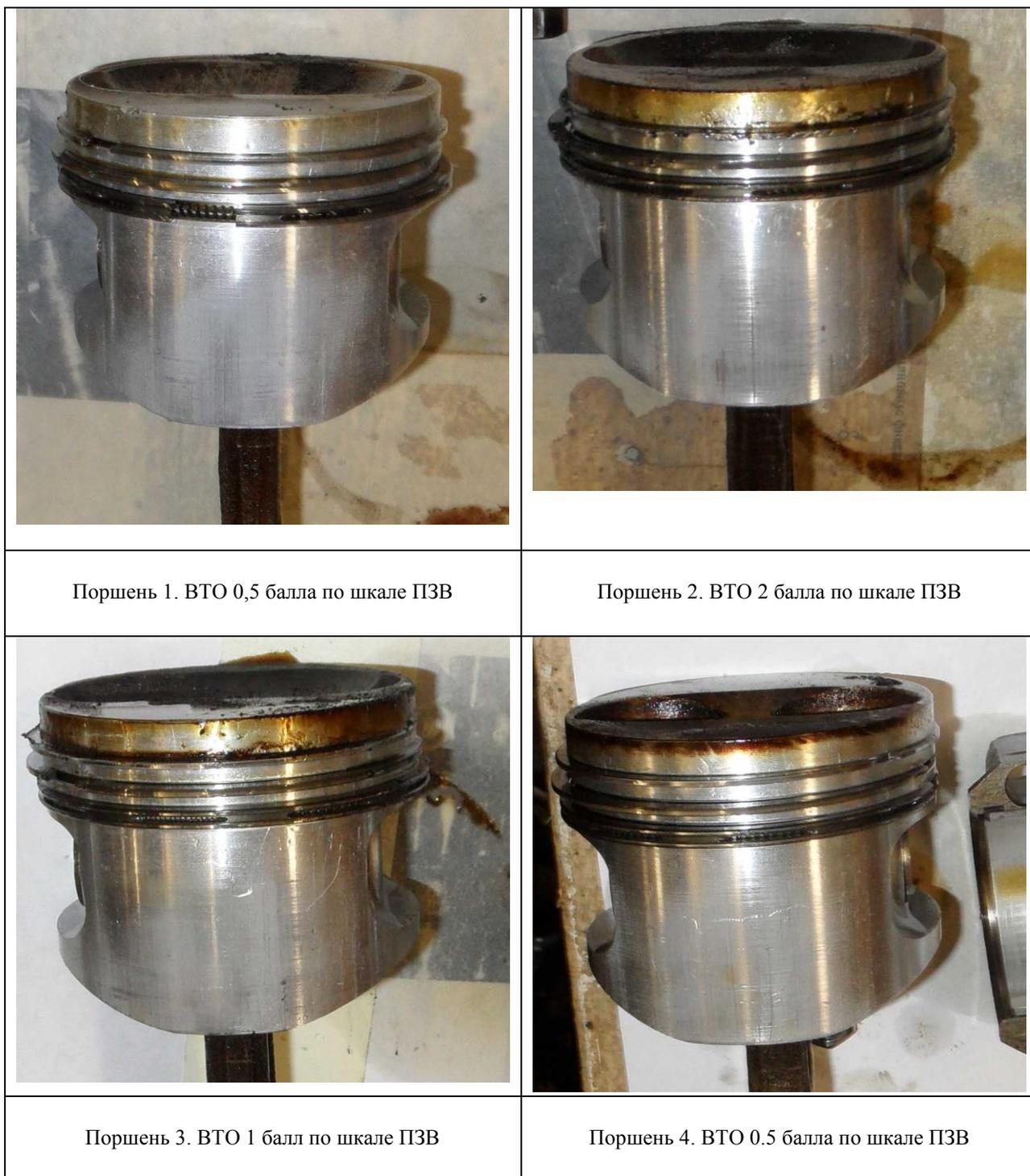
Рис. 48. Высокотемпературные отложения (ВТО) поле длительных испытаний двигателя на моторном масле Castrol EDGE Professional 0W-20 Titanium с iMagnet P14
